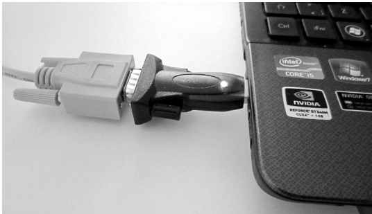
Resim 1.33: Dizüstü bilgisayar ile PLC'nin haberleştirilmesi
